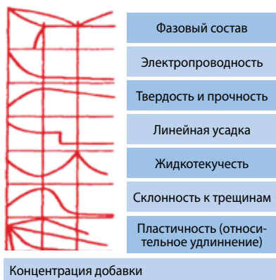
Рисунок 2 – Зависимость свойств сплава от концентрации легирующей добавки
