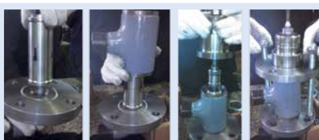
Рисунок 13 – Последовательность сборки клапана модульной конструкции
