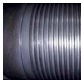
Рисунок 2 – Покрытие MODENGY 1002 после 3-го свинчивания
