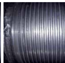
Рисунок 3 – Покрытие MODENGY 1002 после 4-го свинчивания
