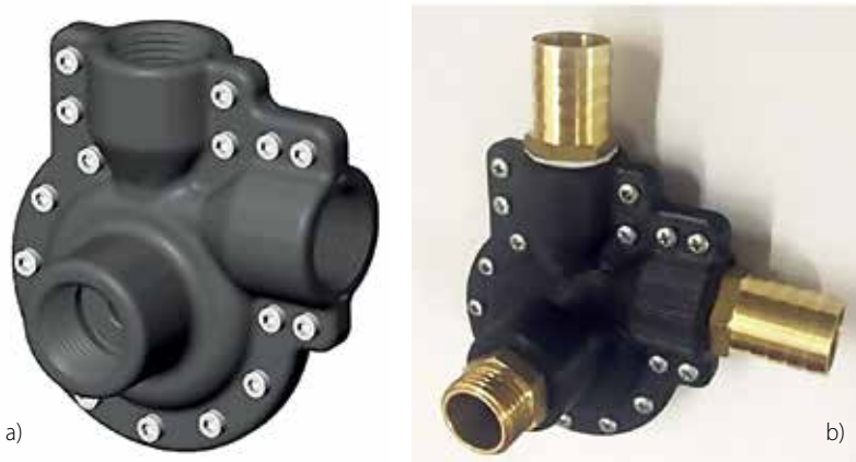
Рисунок 6 – Трехмерная модель вихревого регулятора (а); экспериментальная модель (б)
